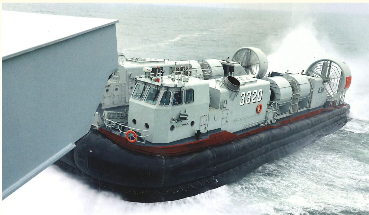
071型兩棲船塢運輸艦(如圖所示)和075型直升機船塢登陸艦都在艙部塢艙從事726型氣墊登陸艇作業。這些登陸艇可以用40節的速度運送60噸的酬載，進一步改變登陸作戰的性質。(Source: Massimo Annati)
